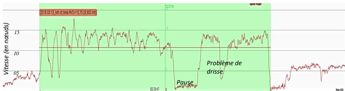
Figure 8. Extrait de la courbe de vitesse du bateau. La zone en vert correspond à la séquence de vol présentée dans l'Exemple 1 (cas 2). La ligne horizontale rouge représente la vitesse moyenne sur cette séquence. L'échelle est indiquée par les lignes grises horizontales, l'écart entre deux lignes correspondant à cinq nœuds. Nous pouvons distinguer sur cette courbe la première partie du bord, avec une vitesse très variable, suivie de la pause durant laquelle l'entraîneur a donné de nouvelles consignes, puis la deuxième partie du bord comportant une chute de vitesse momentanée lié à un problème avec la drisse de spi.
