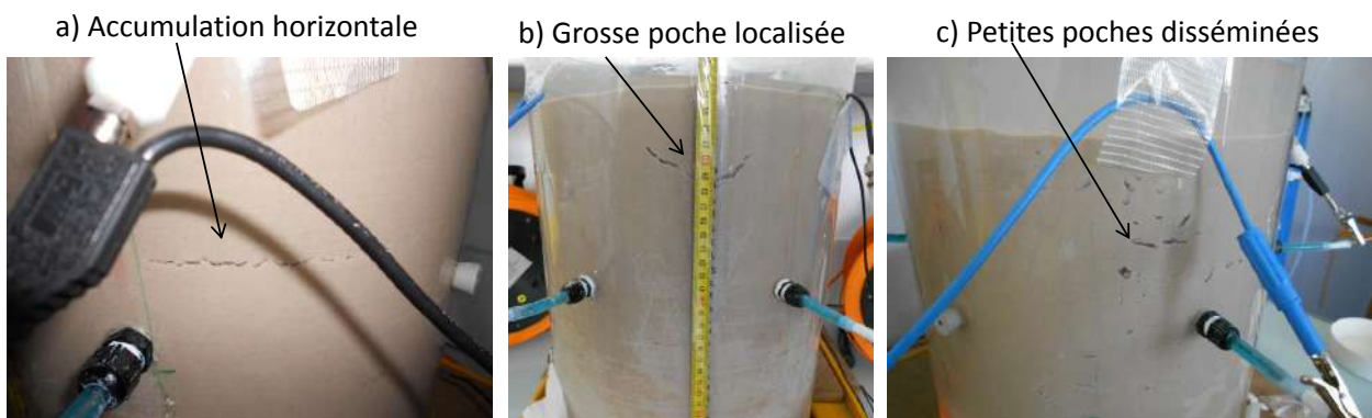
FIGURE 4.30 – Photos représentant quelques modifications structurales que l'on a pu observer au cours de nos expériences. a) Fracture horizontale. b) Grosse poche localisée, ici après dégonflement. Lorsque gonflées, elles peuvent faire autour de 3 à 5 cm de largeur. c) Petites poches disséminées.
