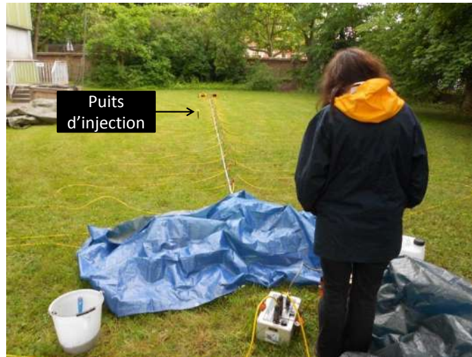
FIGURE 5.6 – Photo représentant une ligne d'électrodes mise en place avec la méthode PPT lors de mesures préliminaires aux expériences. Toutes les configurations d'électrodes utilisées au cours de ces expériences (ERT, PPT et PPS) ont été disposées selon le même axe.
