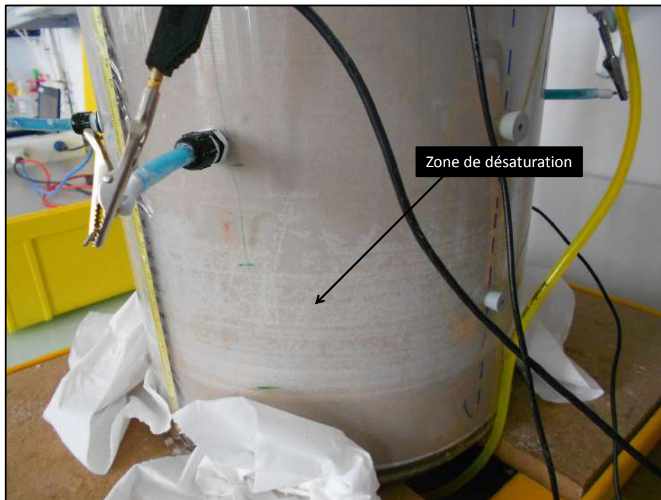
FIGURE 3.34 – Exemple de zones de désaturation observées lors des expériences en laboratoire décrites au chapitre 3. Dans une zone décimétrique située immédiatement au dessus du diffuseur, le gaz forme une chambre d'accumulation aussi large que le cylindre.
