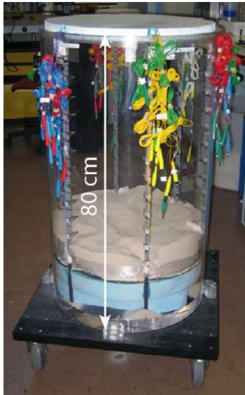
FIGURE 3.1 – Réservoir cylindrique instrumenté de 60 électrodes. Un système valve / passe-paroi monté sur le fond du réservoir permet l'injection de gaz par le dessous. Extrait de Vieira (2013).
