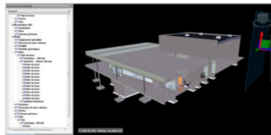
Figure 8-10 – Exemple d'intégration sous Naviswork pour analyse des métrés et visualisation du phasage global de chantier
